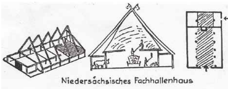
Schema eines niederdeutschen Fachhallenhauses
